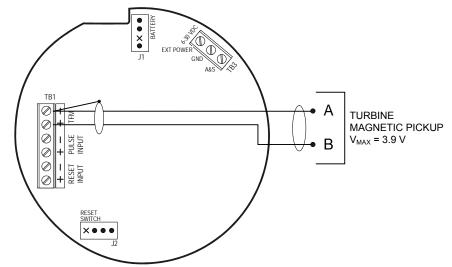
Figure 2.9—Flowmeter input wiring
