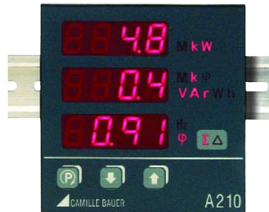
A210 DIN Rail Installation
